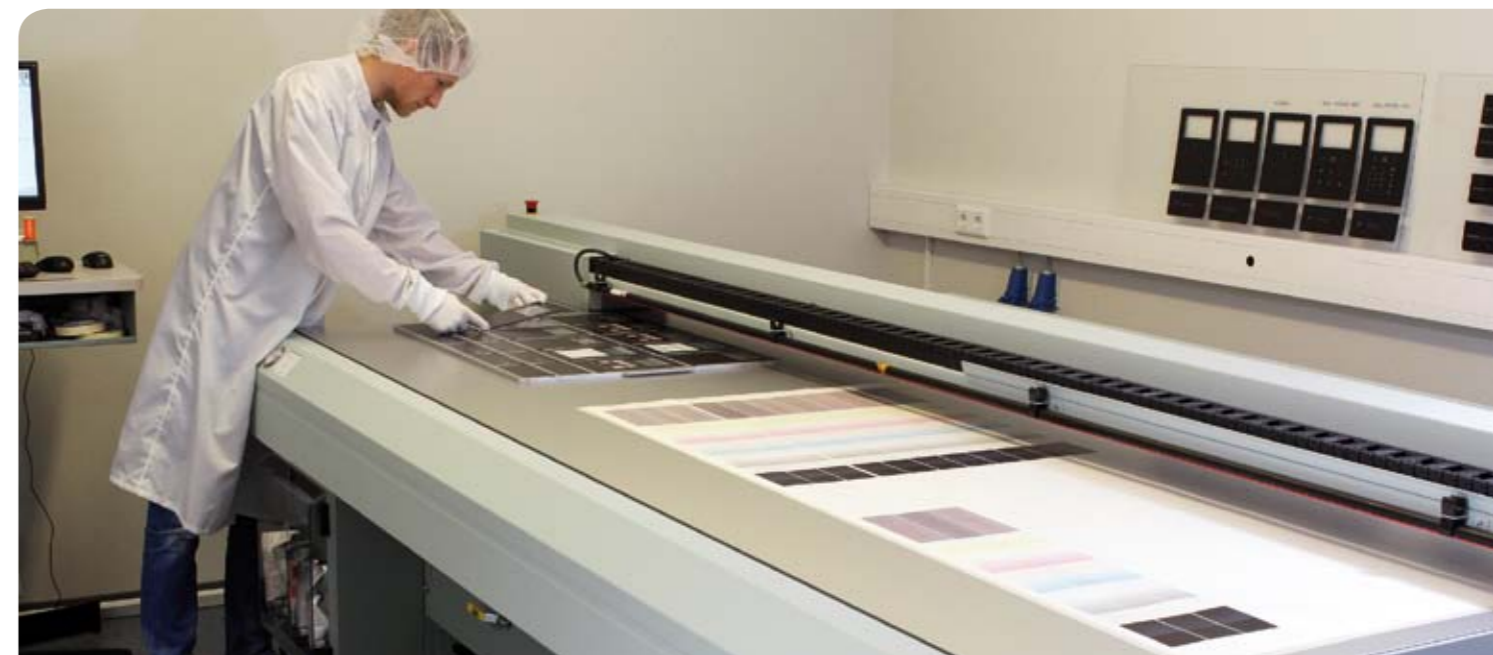
digitales Glasdrucksystem zur Individualisierung der Datafox EVO-Line
