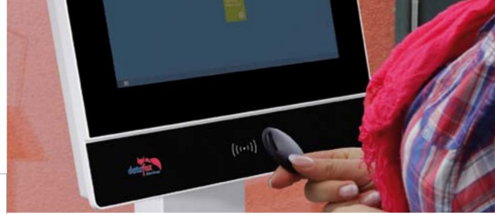
Datafox Zutrittsterminal mit RFID, Fingerprint und Funktion als Zutrittsknoten.
