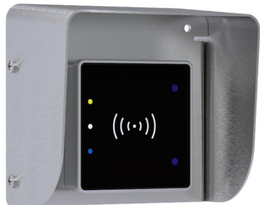
Nun den EVO Intera II anschließen, in die Wandhalterung einhängen und mit der Senkkopfschraube aus der Standardlieferung fixieren. Als letztes die Schutzfolie von der Haube abziehen und diese mit den 4 Linsen - Flanschkopfschrauben M4x6 an der Rückwand montieren.
