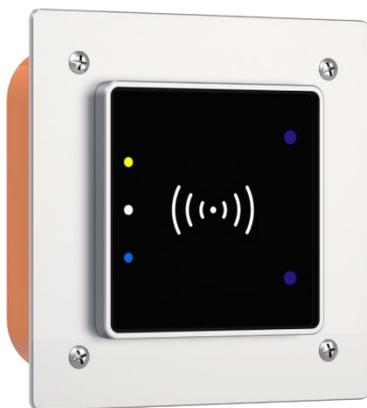
Nun das Frontblech auf den Verbindungskasten bzw. die Wand montieren. Hierzu verwenden Sie die 4 entsprechenden Blechschrauben mit Senkkopf. Die kürzeren mit 16mm in Verbindung mit dem Verbindungskasten. Die 30mm Schrauben bei Direktmontage mit den Dübeln.
