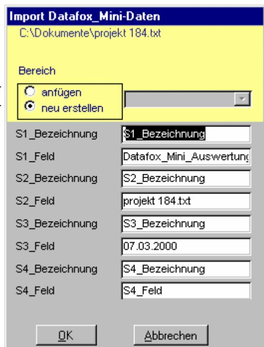
Auswahl des Bereiches oder der Studie, an die die aufgerufenen Datafox – Mini Daten angefügt werden sollen.
