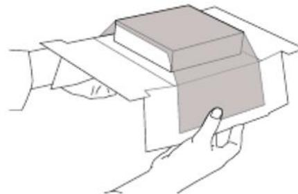
Beide Flügel vollständig umklappen → Folie spannt sich.
