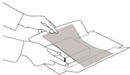
Beide Flügel hochziehen und Produkt unter Folie platzieren.
