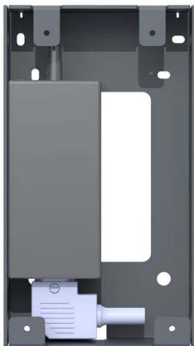
Montieren Sie das Wandgehäuse über die 4 innenliegenden Bohrungen an die Wand. Verwenden Sie hierzu die Dübel, Schrauben und U-Scheiben aus dem Beipack der Wandhalterung. Die 4 äußeren Bohrungen entsprechen den Positionen der Wandhalterung und können genutzt werden, wenn die Einheit um die Wanddose erweitert wird.
