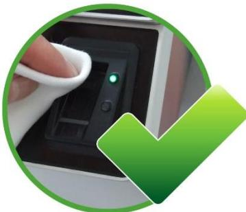
Zum Entfernen von Verunreinigungen dürfen auf keinen Fall Scheuermilch oder ätzende Reinigungsmittel verwendet werden. Insbesondere die Displays, als auch die Tastatur und Fingerprintmodule sind vorsichtig zu reinigen.
