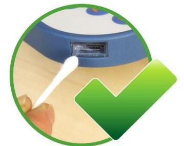
Bei Verschmutzung der Laserscannerfenster müssen diese gereinigt werden, um die einwandfreie Scan-Funktion zu erhalten.
